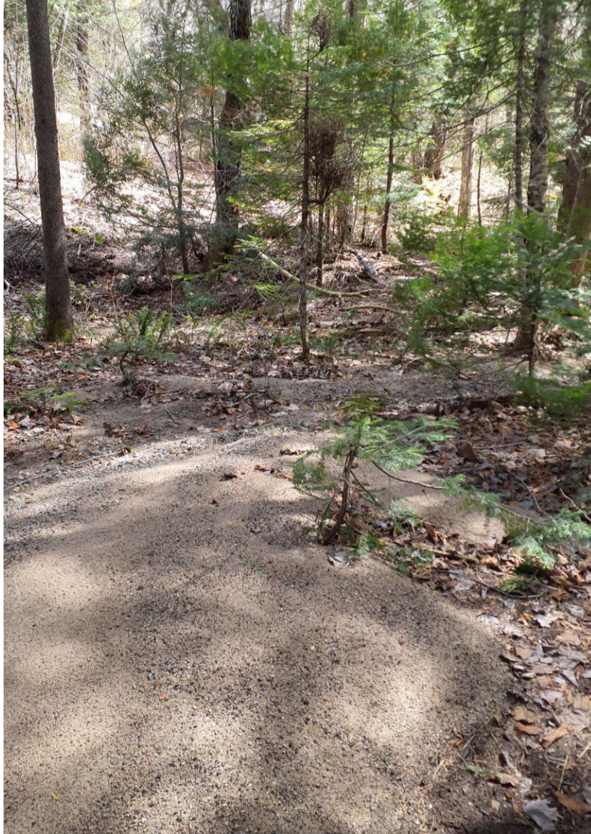
Figure 3 : Exemple d'accumulation sédimentaire provenant d'un ponceau qui draine la montagne (Lam-Er-14) et causée par des processus de ruissellement de surface dans le bassin versant du lac Lambert, 2024
